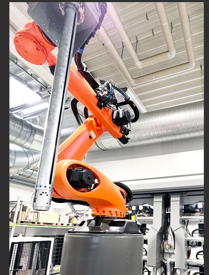
Kuka-Roboter bei der bestückung einer 10-Farb Flexodruckmaschine
