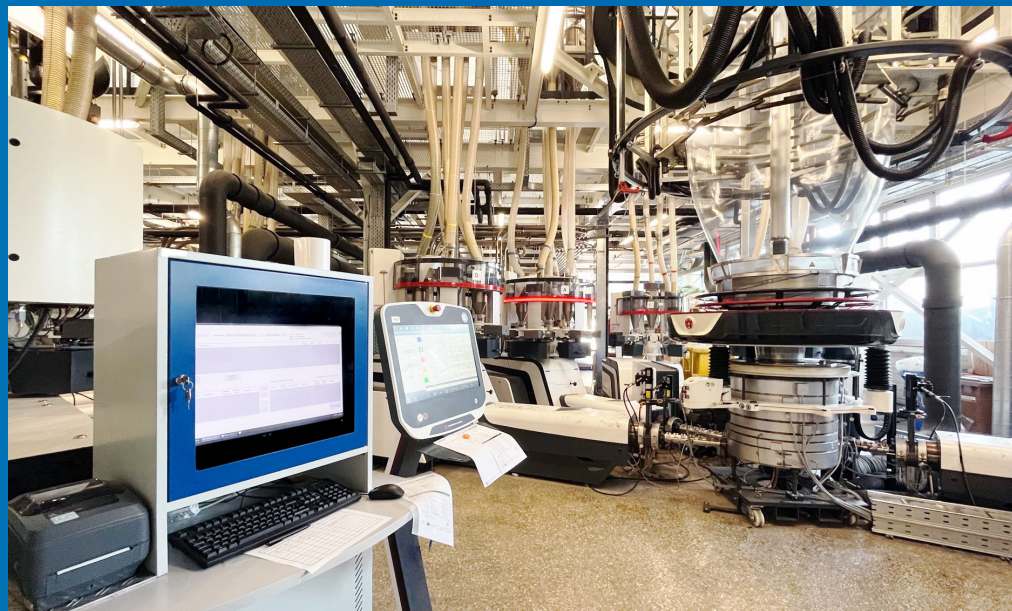
ThinClients in Zusammenarbeit mit einem 5-Schicht Blasfolienextruder
