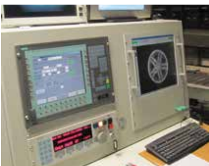
Weitere Anwendung für den Einsatz von Thin Clients: Per VNC wird die Bildschirmausgabe einer vollautomatischen Felgen-Röntgenanlage zur Qualitätssicherung an den Steuerungsarbeitsplatz projiziert. Quelle: Ronal
