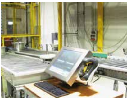
An zahlreichen Stellen in der Produktion stehen Terminals mit Barcode-Scannern zur Kontrolle und Überwachung des Warenflusses. Quelle: Ronal
